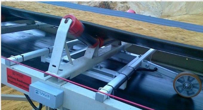
**Bandwaage mit wartungsfreiem robusten Wiegerahmen zum kontinuierlichen Wiegen. Leicht nachrüstbar in vorhandene Förderbänder. Sehr gut für mobile Anlagen geeignet (Typ BS).**
